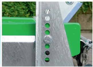
System regulacji wysokości cięcia liczący 8 pozycji
